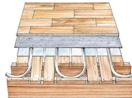
Figur 7.6. Trægulve på strøer eller bjælkelag med varmefordelingsplader på bærebædder kan være meget eftergivelige, hvis bærebædderne er for tynde, eller hvis der er udkragede ender (ved vægge). (Kilde: TRÆ 64, Trægulve lægning, E. Brandt, 2010)
